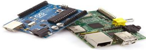
شكل (1) لوحة تحكم أردوينو ولوحة تحكم راسبيري
