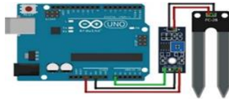
الشكل (14) توصيل حساس رطوبة التربة
